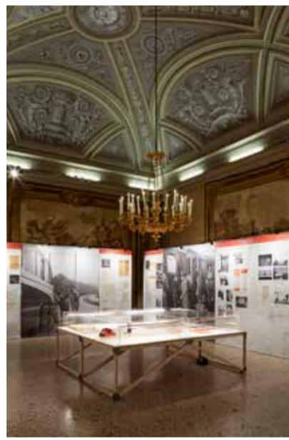
**U**n sistema di allestimento a telai disegnato per mostre itineranti. Formato da cavalle e traversi in legno massello o alluminio assemblati con snodi in acciaio, è completato da pannelli in materiale leggero o teli, come supporto per testi e immagini o anche da piani orizzontali e teche per l'esposizione di oggetti.
