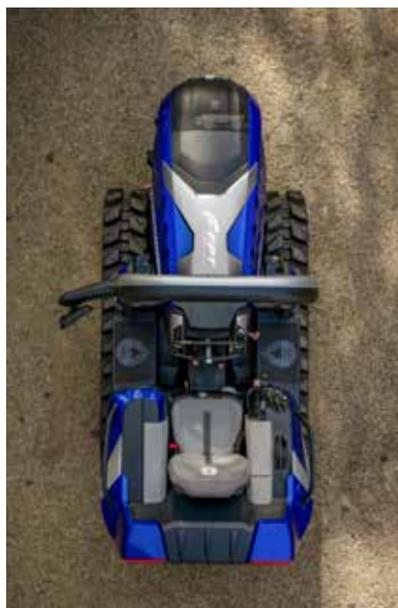
**P**rogettato per Fontanafredda, tenuta storica delle Langhe, Piemonte, per l'applicazione specializzata in vigneti collinari, è studiato per migliorare l'ergonomia e la funzionalità. La carenatura ha superfici fluide che danno maggiore protezione alle viti, coprendo spigoli o meccanismi che possano danneggiarle.
